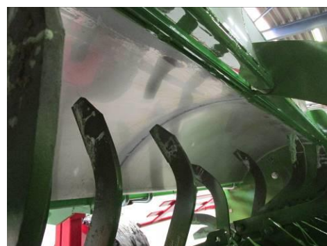
Voorplaat en inspectieluiken met kunststof voor steenvrije grond
