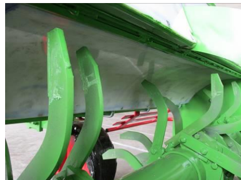
Voorplaat en inspectieluiken met kunststof voor steenvrije grond
