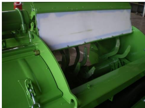
Voorplaat en inspectieluiken met kunststof voor steenvrije grond
