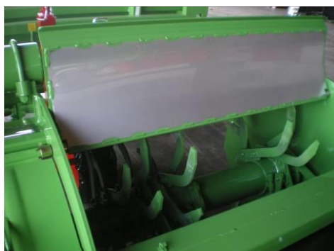
Voorplaat en inspectieluiken met kunststof voor steenvrije grond
